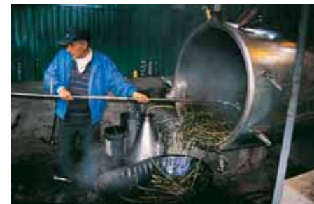
DESTILLATIONSANLAGE FÜR PFEFFERMINZE
